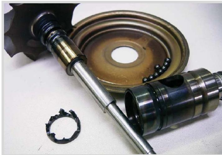
*Cartucho de rodamientos sobrecalentado, lo hemos desarmado para ver los daños en el retén (abajo a la izquierda). Las pistas también están azuladas y dañadas. Una holgura excesiva es el resultado del daño en el retén y las pistas, y por lo general acabo produciendo el roce de las turbinas con sus caracolas, y como consecuencia la destrucción del turbo.*
