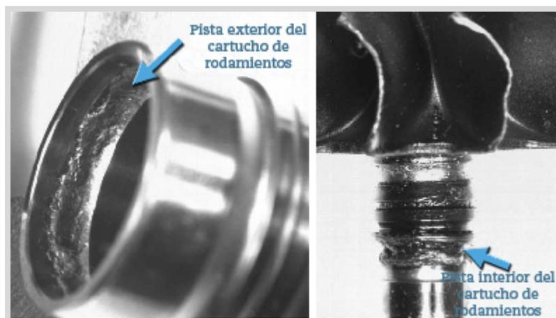
*Pistas de los rodamientos dañadas por el intenso calor y las altas revoluciones. Los rodamientos han estado funcionando en condiciones muy desfavorables sobre estas superficies.*
