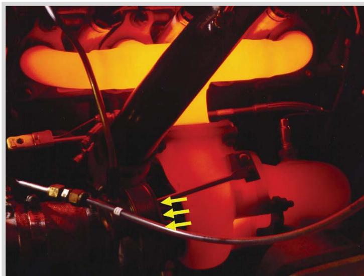
*Las altas temperaturas que permanecen en el colector y la caracola de escape una vez que el motor se ha apagado, se irradian por convención al interior del turbo (en la dirección de las flechas amarillas) donde puede dañar los rodamientos y los segmentos.*
